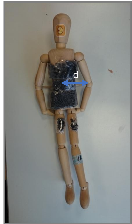
Abbildung 4: Versuchspuppe; die gezeigte Strecke d wird variiert
