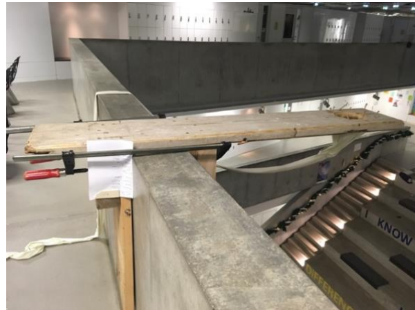
Foto 2: Befestigung des Versuchsschlauchs
